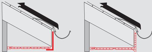
Für ausreichende Hinterlüftung Sorge tragen. Die Paneele mit passenden rostfreien Profildrehtornieten, bzw. Edelstahl-Nägeln oder -Schrauben befestigen. Für Dekor-Paneele und Hartschaumwinkel stehen farblich passende Torxschrauben und Polytop-Schrauben bzw. -Nägeln zur Verfügung. An den Enden der Paneele zu den Zusatzprofilen witterungsabhängig einen Spielraum von 5-10 mm einhalten.
