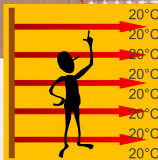
Gleichmäßige Temperaturverteilung mit der Wandheizung
