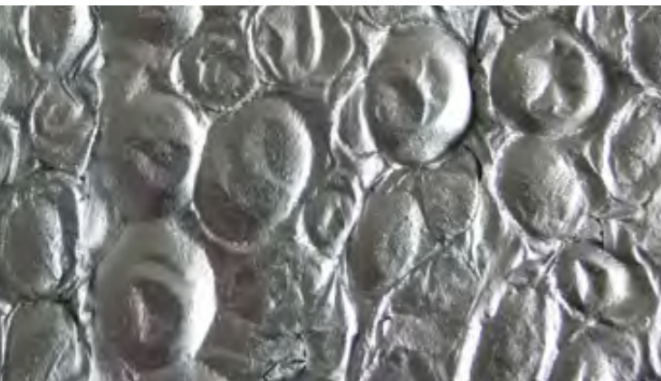
AL-FG-12.7-LG (große Zellen beidseitig geschlossen)
