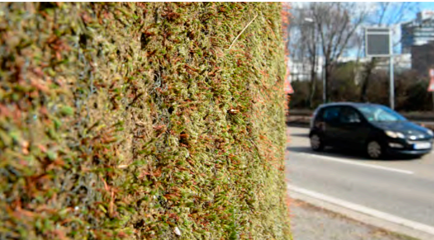
Pilotversuch: Eine 100 Meter lange Mooswand an einer stark befahrenen Straße in Stuttgart. Ziel der Messungen ist es, die Feinstaub reduzierende Eigenschaft von Moos in der Praxis zu testen. Foto oben: dpa / Lino Mirgeler; Foto unten: dpa / Franziska Kraufmann
