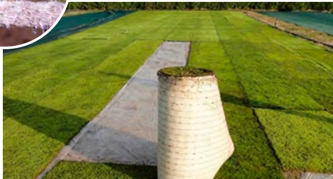
Der Aufbau: Verschiedene Moosarten werden auf ein Vlies aufgebracht, die zusätzlichen Schlaufen sichern gegen Windabtrag. Gerollt lassen sich die Rollen einfach transportieren und installieren.
