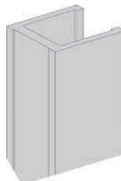
Wandanschluss inkl. Gummieinlage für 8-10 mm Glasstärke (ungebohrt)
