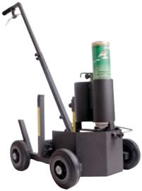
Vielseitiger Markierwagen für Markierungsspray 753, Linienmarkierspray 756 und 2K-PU-Industrie-Markierspray 761. Stabile Blechkonstruktion mit 4 Rädern und Richtungspfeil. Griffanbringung für Rechts- und Linkshänder möglich. Auch für beidseitige Randmarkierungen geeignet. Sprühvorgang mit einer oder zwei Dosen möglich. Variable Strichbreite: 50-120 mm
