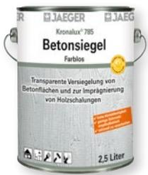
Einkomponenten-Polyurethan-Lack zur Imprägnierung, Verfestigung und Versiegelung von Mauerwerk, Beton, Zementestrich, Faserzement im Innenbereich; für die Imprägnierung von Holzschalungen in der Bauindustrie. Besonders widerstandsfähig gegen Säuren, Laugen und andere Chemikalien. Beständig gegen Lösemittel, z.B. Benzin, Aromaten, Alkohole, gegen mineralische und tierische Öle und Fette, gegen Urin und Desinfektionsmittel, Tausalz, Reinigungs- und Scheuermittel. Verdünnung: Spezial-Verdünnung 97.
