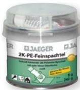
2K-Polyesterspachtel auf Basis von hochreaktiven Polyesterharzen, asbestfrei. Feinspachtel auf Metall, Holz oder Beton, auf mit Jaeger 2K-PE Füllspachtel 418 vorgespachtelten Flächen, zum Ausfüllen kleiner Vertiefungen und Unebenheiten, vielseitig für Reparatur- und Restaurierungsarbeiten verwendbar. Sehr gute Haftung, schnelle Trocknung, gut schleifbar. Ergibt sehr glatte Oberflächen.
