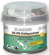
2K-Polyesterspachtel auf Basis von hochreaktiven Polyesterharzen, asbestfrei. Füll- und Ziehspachtel auf Metall, Holz, Beton, zum Ausfüllen von Vertiefungen und Unebenheiten, vielseitig für Reparatur- und Restaurierungsarbeiten verwendbar, auch zum Fixieren von Schrauben oder Dübeln. Sehr gute Haftung, schnelle Trocknung, gut schleifbar. Gute Standfestigkeit auch an senkrechten Flächen, kann auch in dicken Schichten aufgetragen werden.
