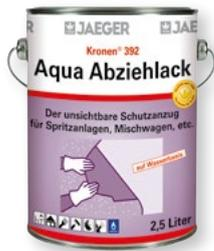
Abziehlack für glatte, nicht saugende Flächen. Zum Überziehen von Metallteilen, die nicht lackiert werden, wie Scharniere, Fenster und Türgriffe, Maschinenteile usw. aus Eisen, Aluminium, Kupfer, Messing, aber auch für glasierte Flächen oder Glas usw.; zum Schutz gegen Verunreinigungen und leichte mechanische Einflüsse.
