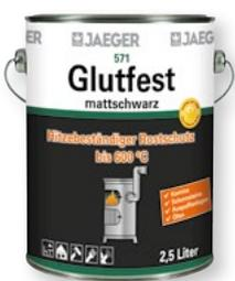
Hochhitzebeständige Spezialfarbe auf Silikonharzbasis mit sehr guten Korrosionsschutzeigenschaften. Für Eisen- und Stahlkonstruktionen, die hohen Temperaturen und großen Temperaturschwankungen ausgesetzt sind wie z.B. Kfz-Auspuff, Heizkessel, Schornsteine, Abgasanlagen, Öfen, Außenflächen von Grills etc. Verdünnung: Spezial-Verdünnung 44. Härtung durch Einbrennen bei 200° C.
