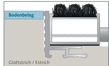
Montage: Der Winkelrahmen muss bündig mit Bodenbelag und Glattestrich / Estrich abschließen
